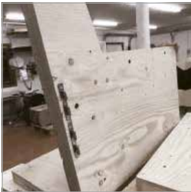
STRONG har kraftigare material, extra förstärkningar under sits samt förstärkt ihopfästning mellan rygg/sits och armstöd.
